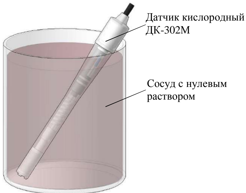
Рисунок 2.11 – Проверка показаний в «нулевом» растворе
